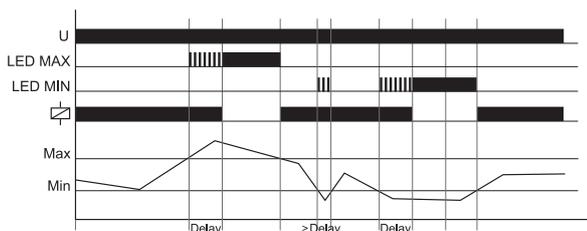
Parpadeando. Al finalizar dicho retardo, el relé de salida R desconecta (El LED amarillo se apaga y el LED rojo MIN se ilumina). En cuanto la tensión supere el valor MIN ajustado, el relé de salida conecta de nuevo (El LED amarillo se ilumina y el LED rojo MIN se apaga).
